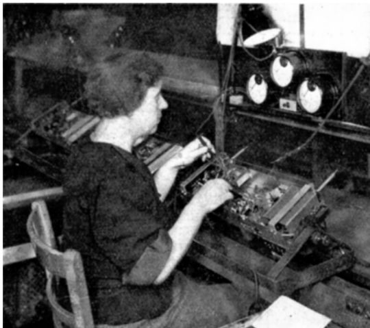
Bei der Herstellung von Rundfunkgeräten reiht sich Messung an Messung. Die Bilder zeigen einige Ausschnitte aus den zahlreichen Meßplätzen einer der führenden Empfängerfabriken. Von links nach rechts: Strom- und Spannungsmessung beim verdrahteten Gerät — Endprüfung in der Prüfkabine — Hochspannungsprüfung des Drehkondensators.
